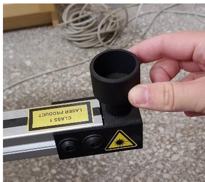
Abb. 7 Die Kappen der Laser-Module können gedreht werden, so dass eine Veränderung und Neuausrichtung der Laserlinien möglich ist (Abb.: A. Skolik/DAI).
