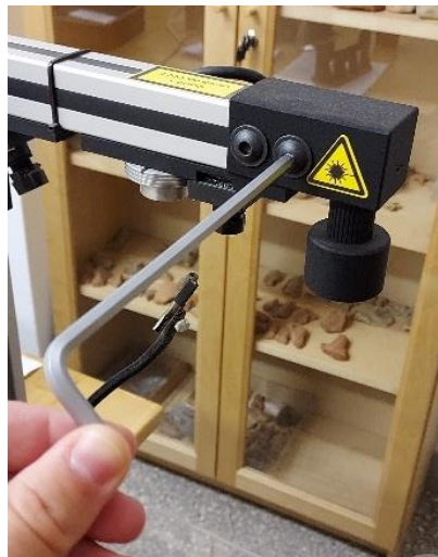
Abb. 6 Mithilfe des Sechskantschlüssels können die Verschraubungen gelöst und Nachjustierungen vorgenommen werden (Abb.: A. Skolik/DAI).
